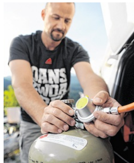
Sicherer Transport: Vor der Fahrt drehen Camper den Gasabahn zu und montieren den Druckminderer ab.
